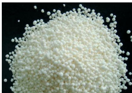
Substance dangereuse : stock d'ammonitrate inflammable.
