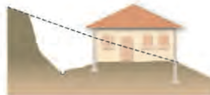
Plate-forme en déblais
